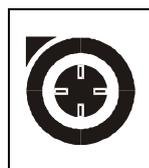
Simbolo del motore aspirazione. Indica l'interruttore del motore aspirazione.
